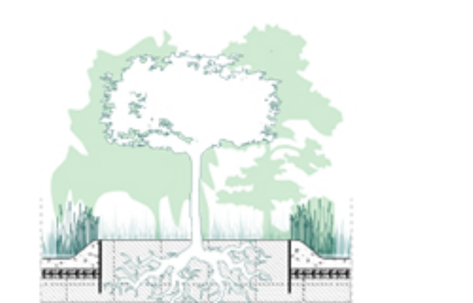
Schutzwand um den Wurzelraum Schutz vor Staunässe und übermäßigem Wasserstress
