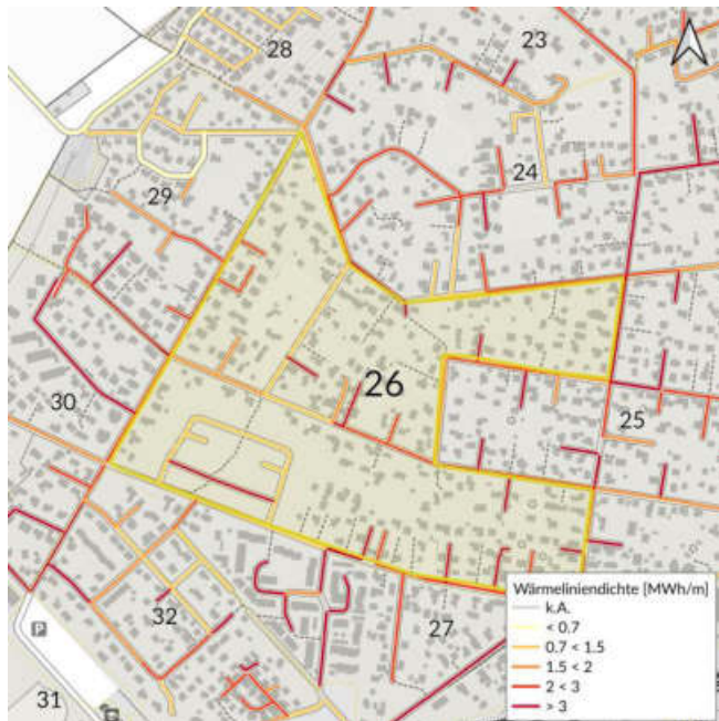
Wärmelinienichte (Indikator für Wärmenetz)
