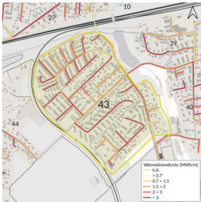
Wärmelinienichte (Indikator für Wärmenetz)
