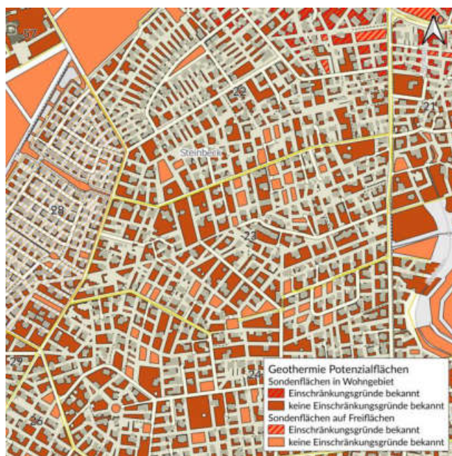
Nutzung von oberflächennaher Geothermie durch Erdwärmesonden
