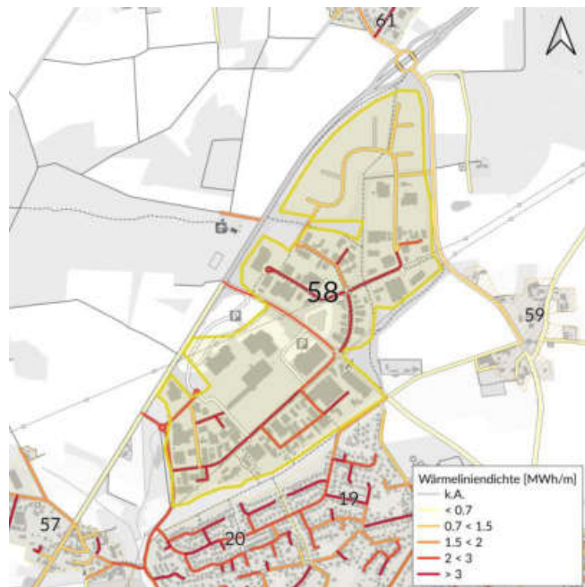
Wärmelinienichte (Indikator für Wärmenetz)
