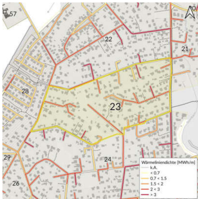
Wärmelinienichte (Indikator für Wärmenetz)
