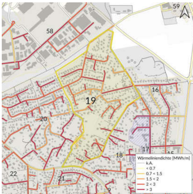
Wärmelinien-dichte (Indikator für Wärmenetz)
