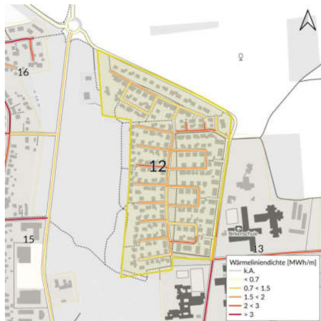
Wärmelinienichte (Indikator für Wärmenetz)
