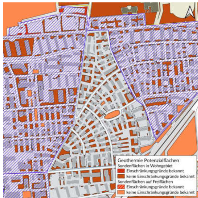
Nutzung von oberflächennaher Geothermie durch Erdwärmesonden
