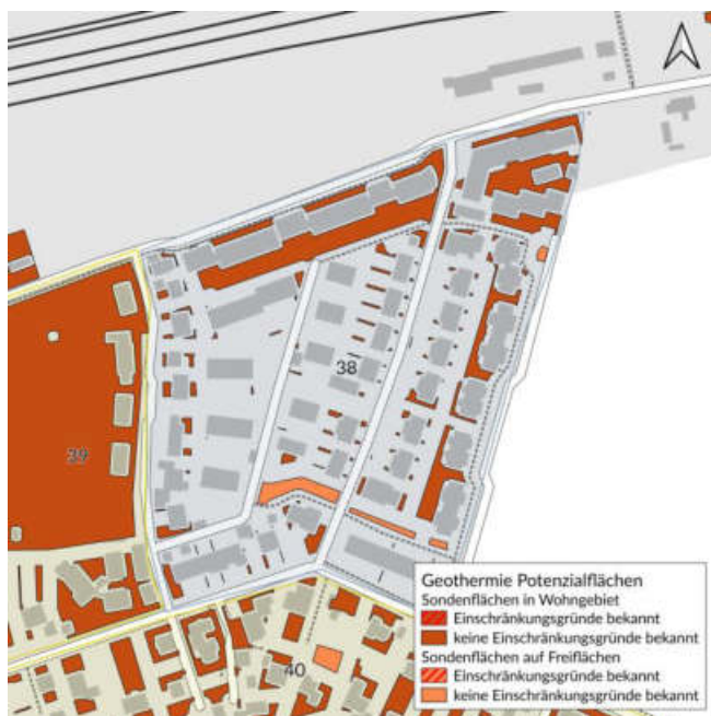
Nutzung von oberflächennaher Geothermie durch Erdwärmesonden
