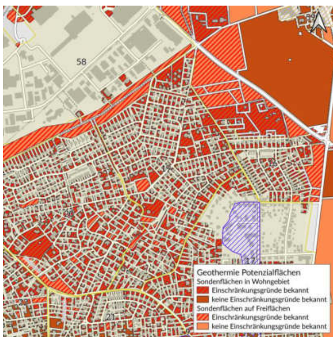
Nutzung von oberflächennaher Geothermie durch Erdwärmesonden
