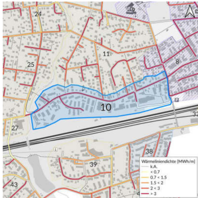
Wärmelinienichte (Indikator für Wärmenetz)
