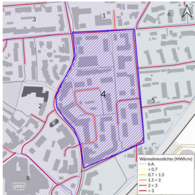
Wärmelinienichte (Indikator für Wärmenetz)
