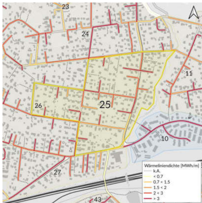
Wärmelinienichte (Indikator für Wärmenetz)
